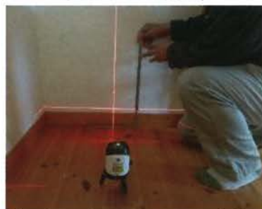
「床の傾きを計測する」調査機器
